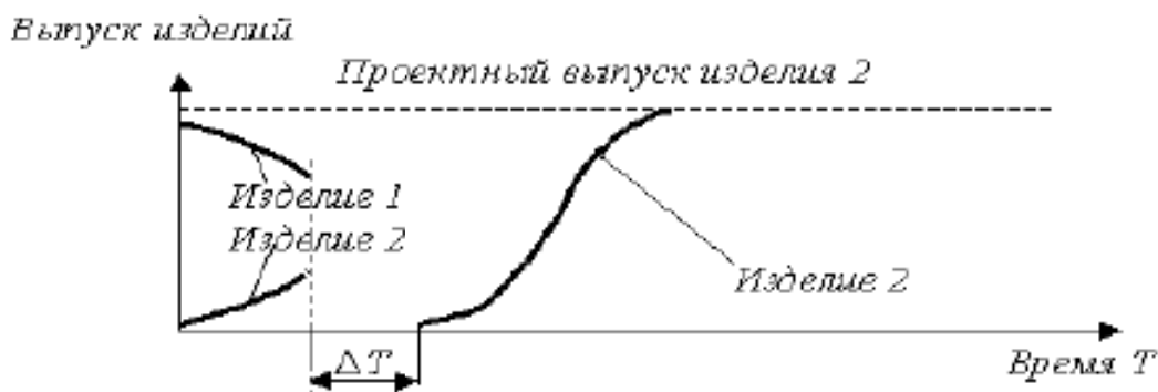
Рисунок 2.3 – Параллельно-последовательный метод перехода на выпуск нового изделия
