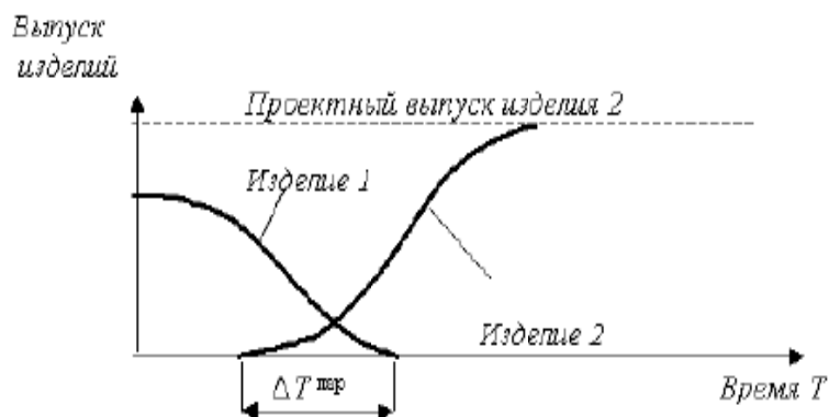
Рисунок 2.2 – Параллельный метод перехода на выпуск нового изделия
